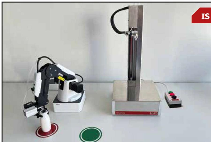
El analizador de hermeticidad no destructivo H5K5.IS está diseñado para realizar pruebas en botellas, potes y frascos con tapas flexibles normalmente selladas por inducción.
