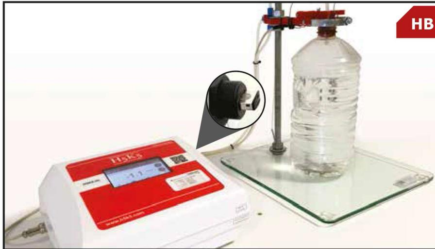
El H5K5.HB es un instrumento diseñado para testear la deformación de botellas plásticas por diferencia de presión de manera fácil, rápida, eficiente y estandarizada.
