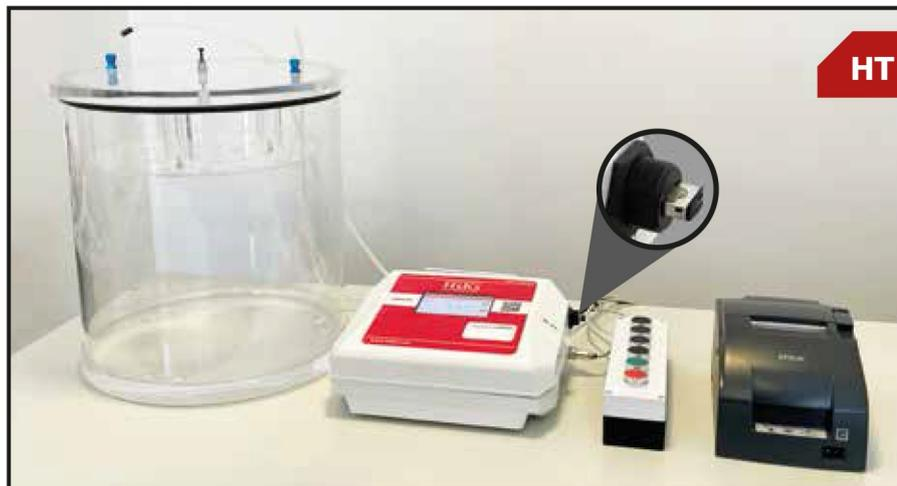
El H5K5.HT es un instrumento diseñado para realizar ensayos de hermeticidad de una manera simple, rápida, eficiente y estandarizada.
